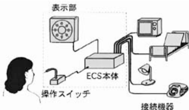
図5 環境制御装置の構成 2)
