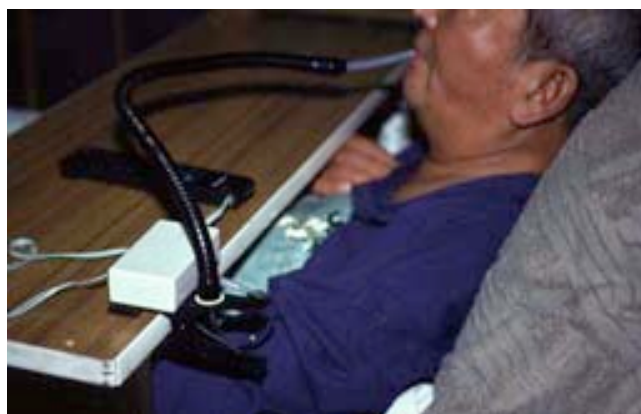
図7 呼吸・吸気によるテレビ操作
